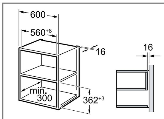
Montar o aparelho a uma altura máxima que permita retirar os acessórios sem problemas. Remover os pés de apoio.
