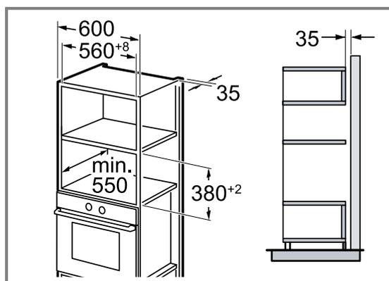
No montar el aparato a demasiada altura, a fin de poder retirar los accesorios sin problemas. Ajustar las patas de apoyo.
