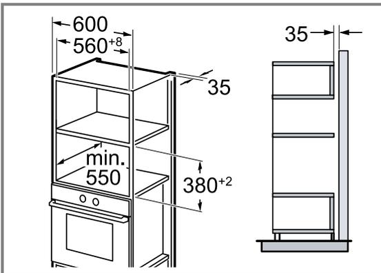
Montar o aparelho a uma altura máxima que permita retirar os acessórios sem problemas. Regular os pés de apoio.
